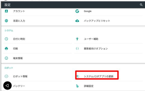
設定画面で「システム/ロボアプリの更新」をタッチし、更新画面を表示します。
