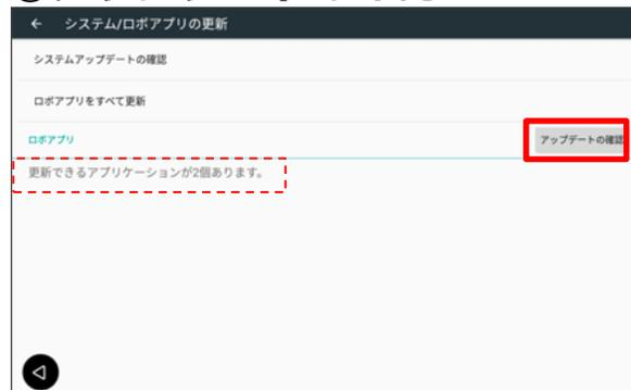
アップデート完了後、「アップデートの確認」を再びタッチし、更新できるアプリケーションが**2個**あることを確認したらPepperを再起動します。これらのアプリケーションは再起動後に反映します。
