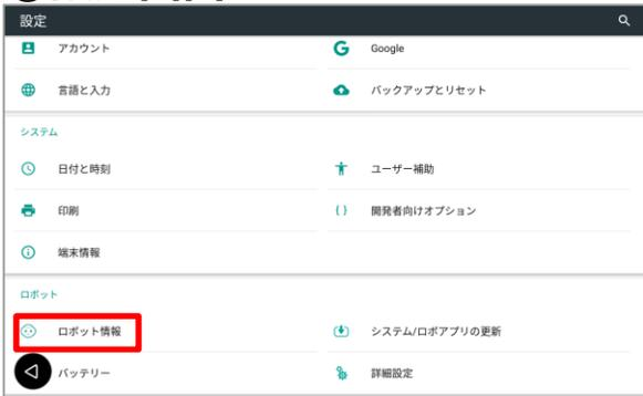
設定画面で「ロボット情報」をタッチし、ロボット情報画面を表示します。
